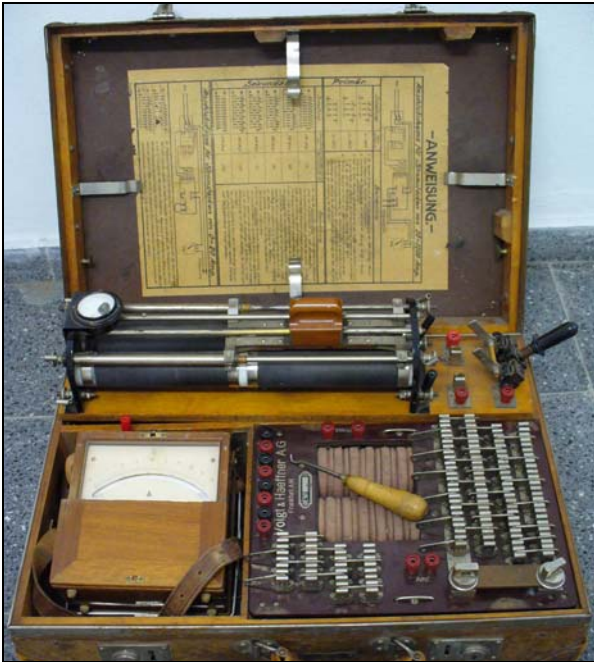
Bild 5: Prüfkoffer, V&H, um 1925
