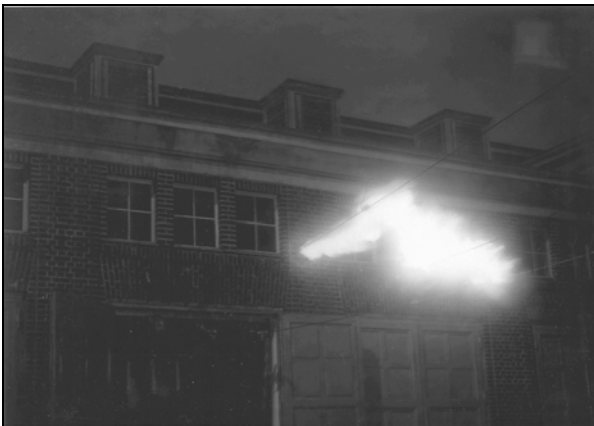
Bild 8: Kurzschlussversuch 50-kV-Netz, Thüringenwerk, 1928
