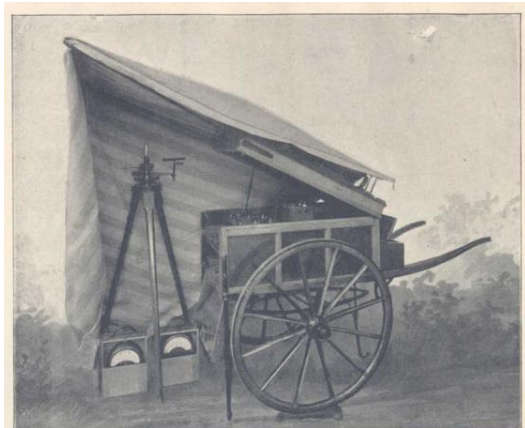
Voiture pour mesures de câbles, avec tente.
