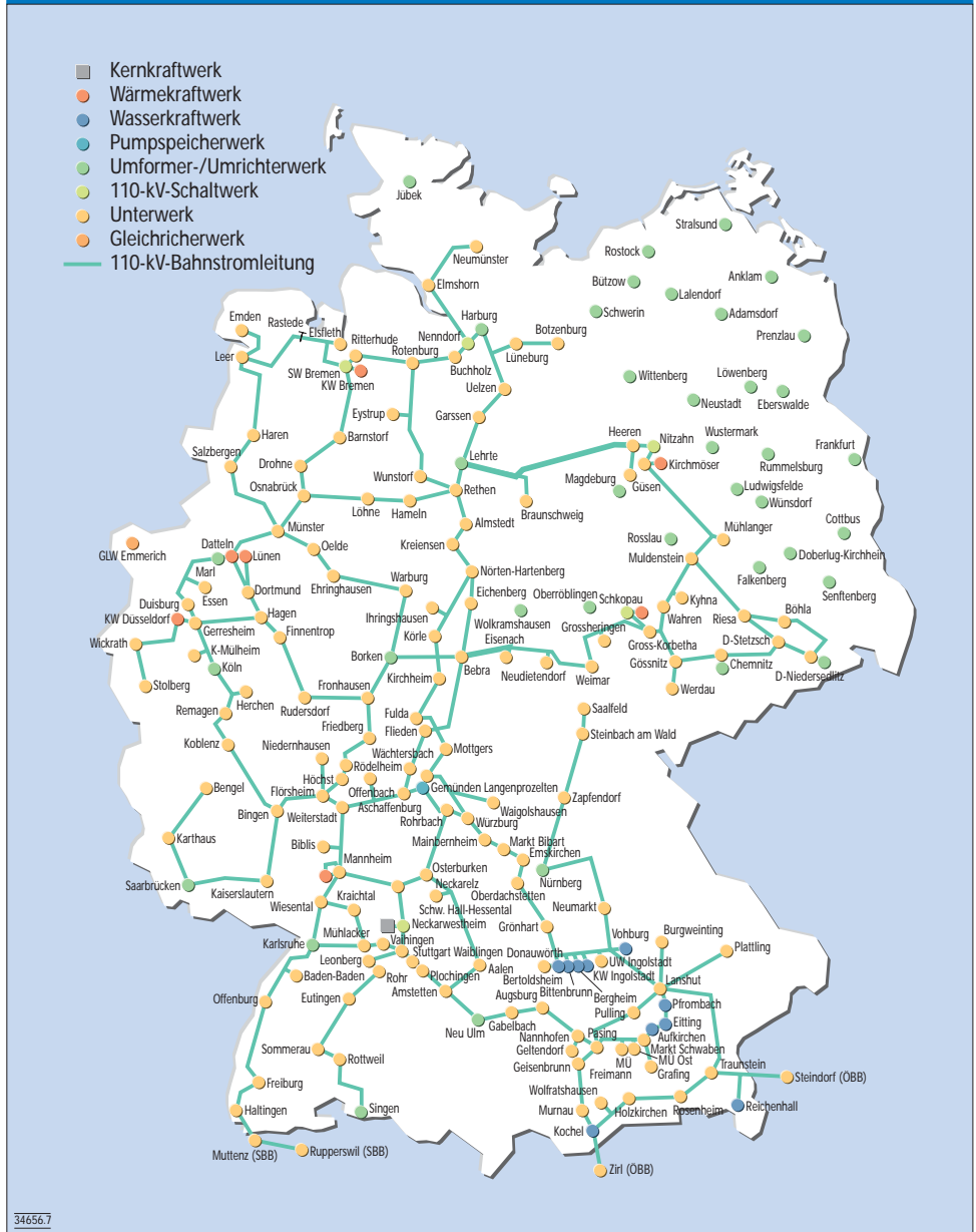
Bild 7. 110-kV-Netz der DB, 16,7 Hz (Frequenzanhebung 1995), Stand 1. September 1996 [5]
