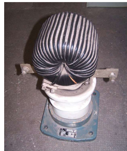
Bild 17: Stromwandler A20P1, SSW, 1925
