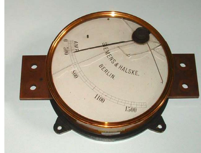
Bild 1: Strommesser auf Potenzial, S&H, um 1890
