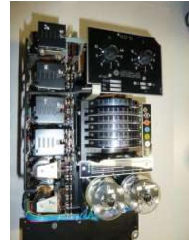
Bei Transformatoren gelangt ab 4 MVA (neben Buchholz und Thermoschutz) Diff.- und Überstromzeit-, später Distanzschutz, zum Einsatz.
