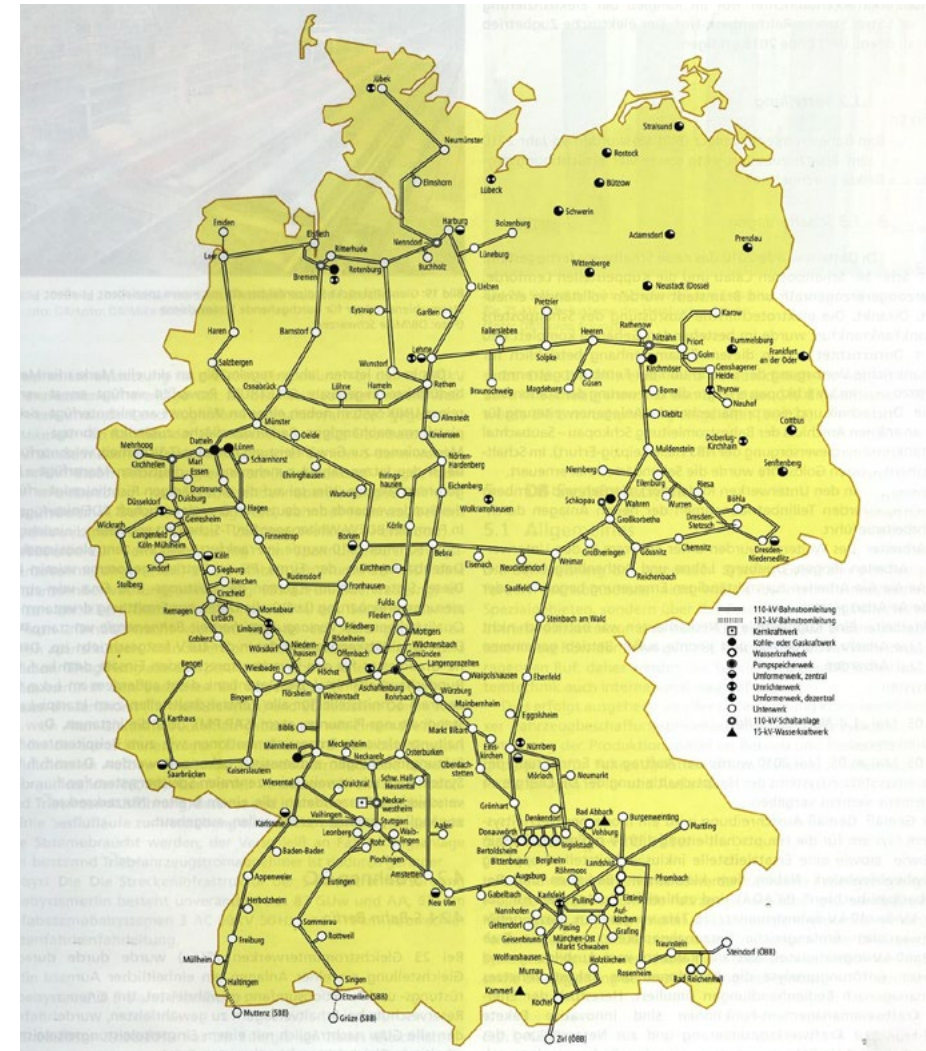
Bild 12: Bahnstromnetz, Erzeuger-, Übertragungs- und Verteileranlagen
