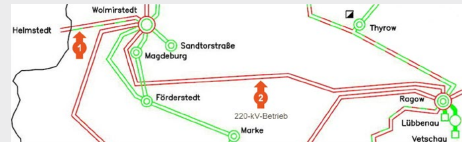
Bild 3: 380-kV-Leitung Helmstedt–Wolmirstedt und bilaterale 220-kV-Richtbetriebe (Netzkartendarstellung in Rot: 380 kV, Grün: 220 kV, Rot/Grün: 220-kV-Betrieb)
